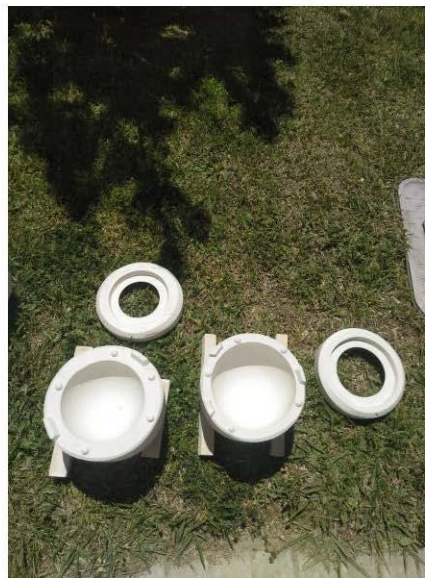
Molde del modelo realizado con la terraja de manivela. .
