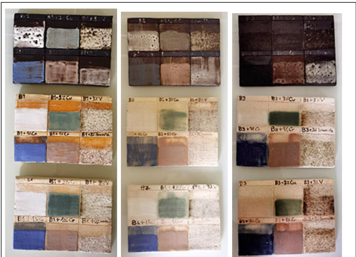
Realización de muestrarios con varias bases de monococión sobre las diferentes pastas que utilizan en el taller
