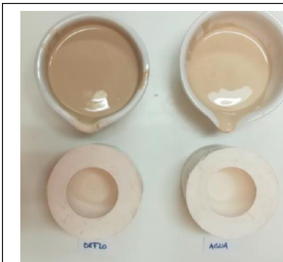
Colada con dos barbotinas de diferente densidad
