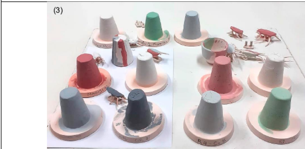
Macrocrystalizaciones con diferentes óxidos colorantes de la cocción
