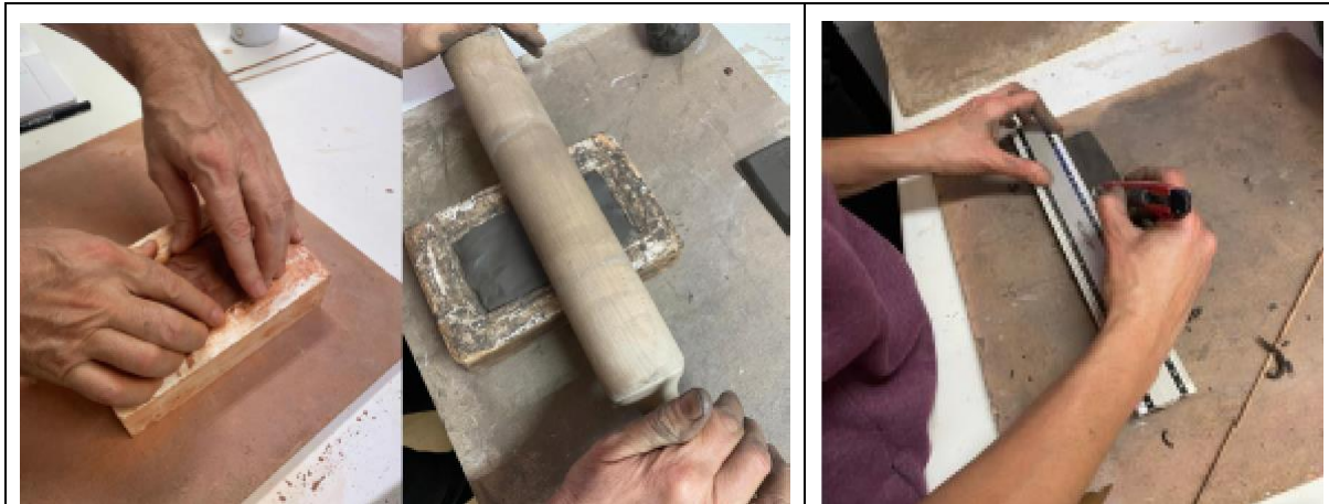
Preparación de las probetas por apretón en molde de escayola
