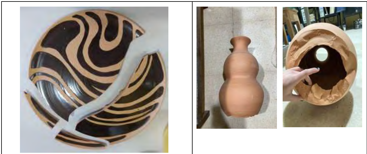
Rotura por tensión del esmalte en la cocción final
