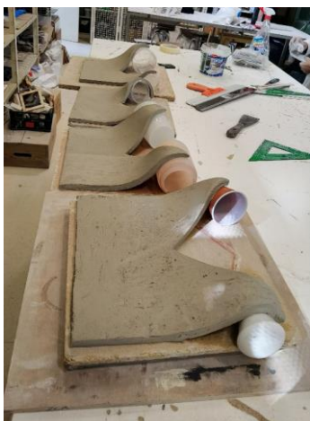
Taller: Elaboración y conformado de planchas
