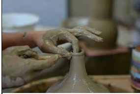
Cortando la boca
