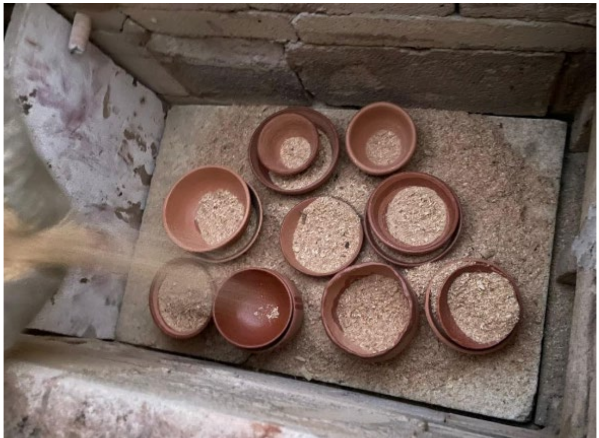
Cargando el horno para carbonación
