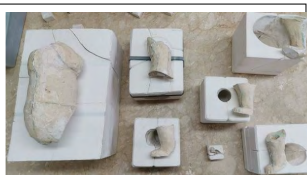
Moldes realizados con de cada una de las partes del despiece del modelo
