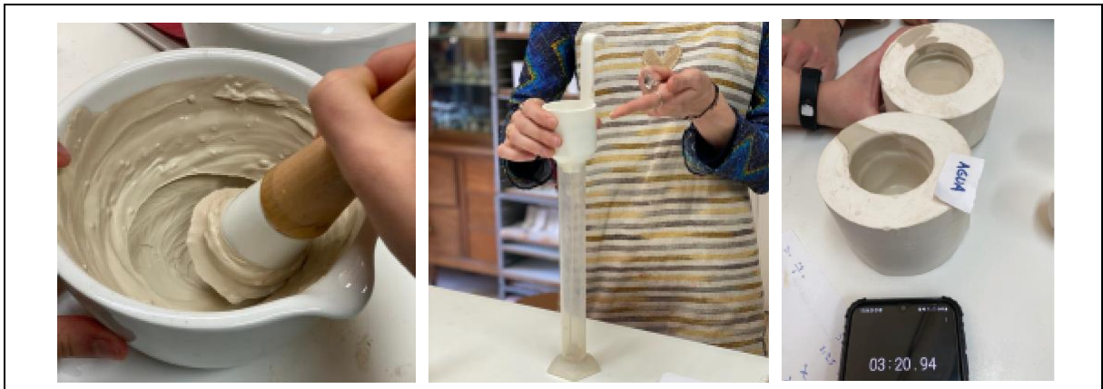
Diferentes etapas para el cálculo de la curva de defloculación
