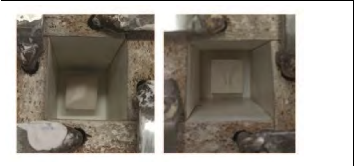
Encofrado de los dos modelos propuestos para la realización de sus moldes en silicona
