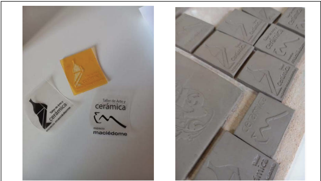
Elaboración de fotolitos y matriz flexográfica. Resultado de sellos sobre gres crudo.
