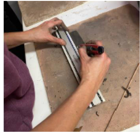
Registro de las medidas para el cálculo de la contracción lineal
