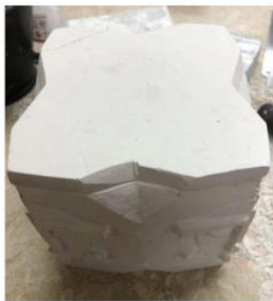
Modelo final listo para proceder a realización de molde por piezas
