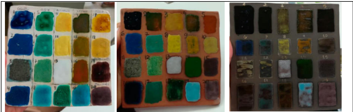
Bases de baja temperatura con un óxido colorante después de la cocción
