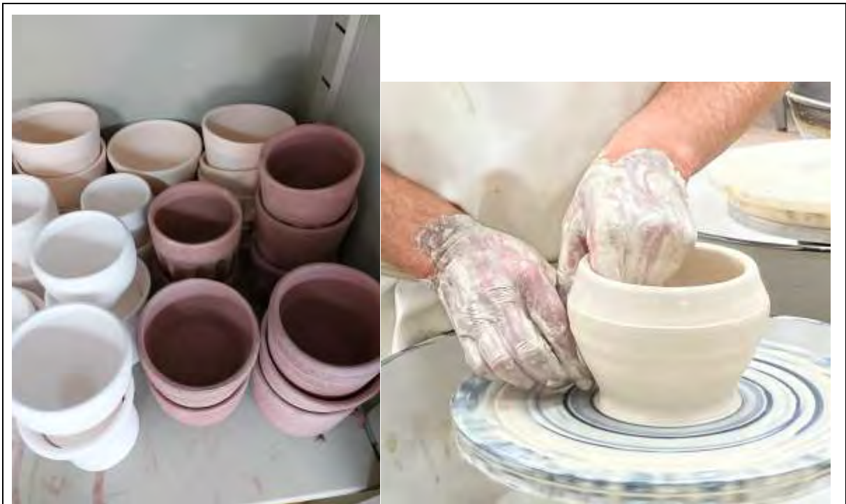
Cuencos en porcelana, refractario y gres para muestras de esmaltes de alta 1240 a 1270°C
