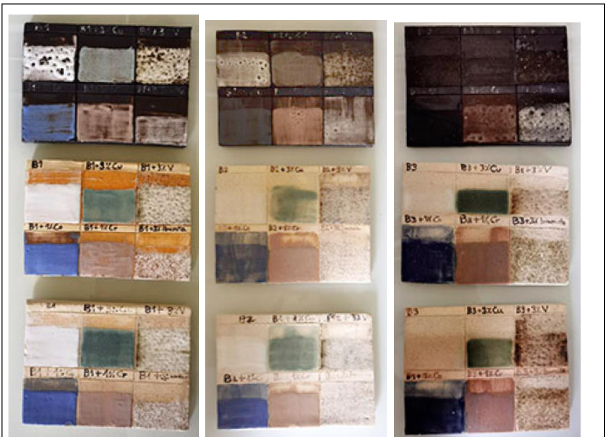
Realización de muestrarios con varias bases de monococión sobre las diferentes pastas que utilizan en el taller
