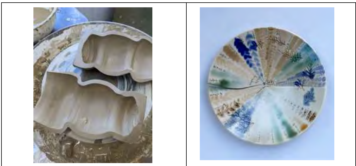
Corte de las piezas para comprobar el grosor.
