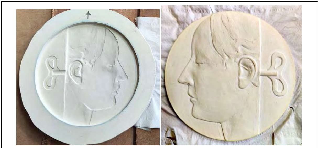
Molde de caja y reproducción en porcelana por colada todavía en crudo
