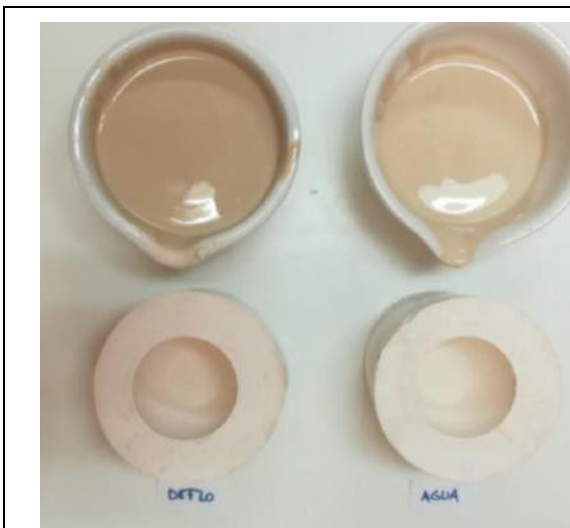
Colada con dos barbotinas de diferente densidad
