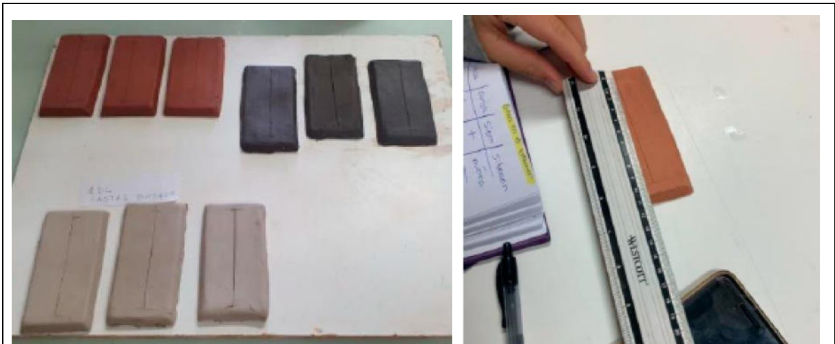
Probetas de diferentes pastas para cálculo de la contracción y la porosidad
