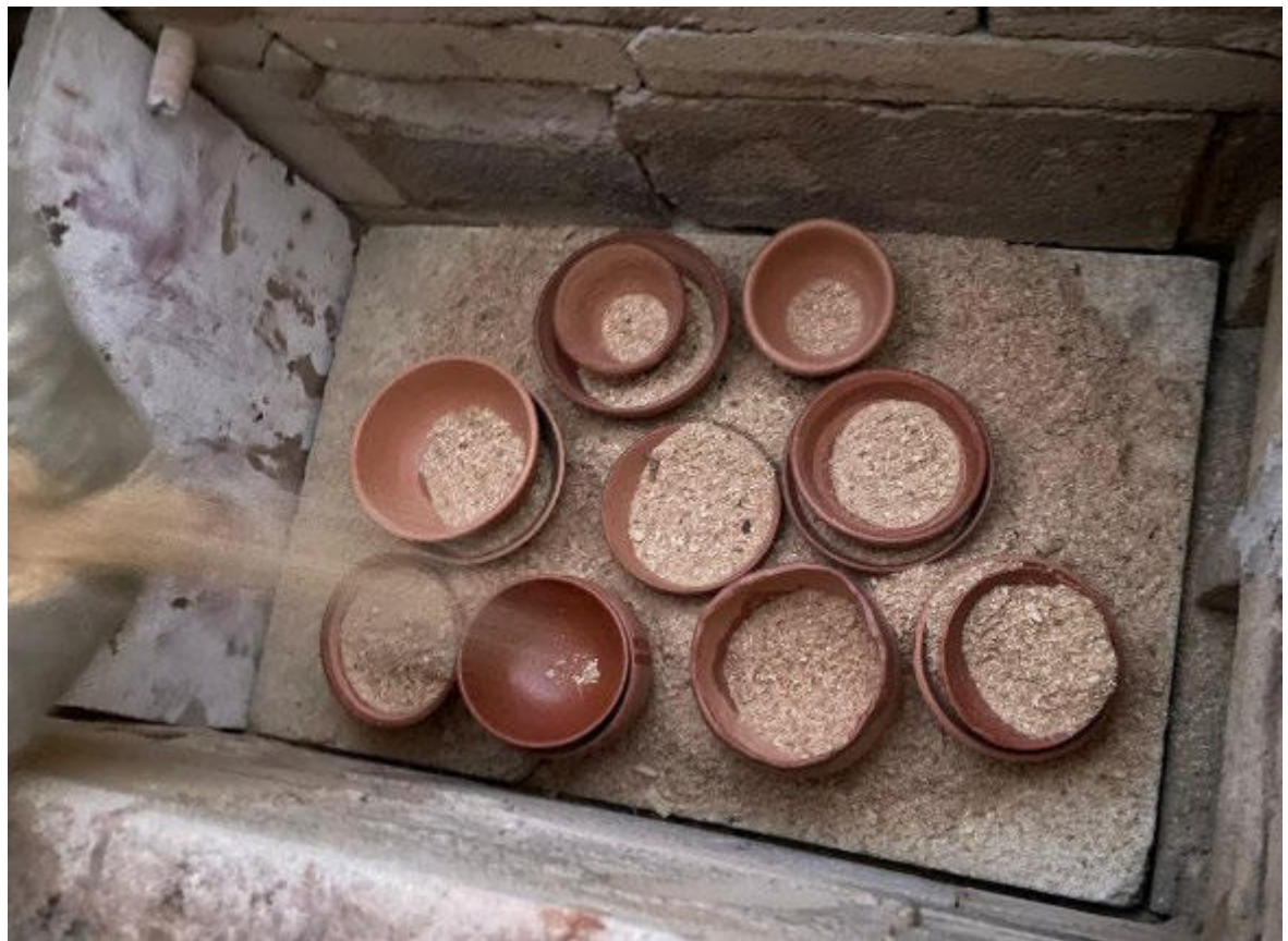
Cargando el horno para carbonación
