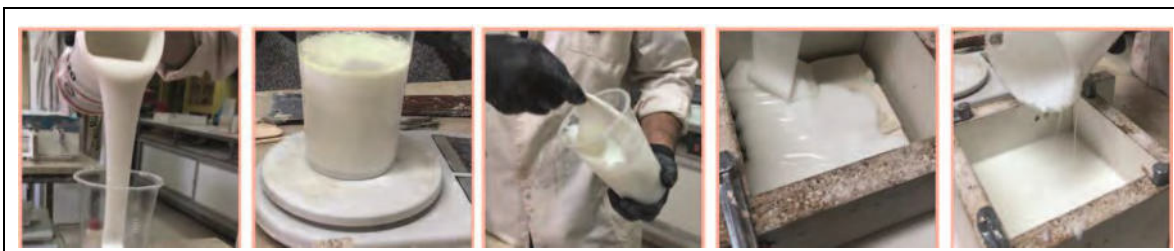
Preparado de la silicona y catalizador
