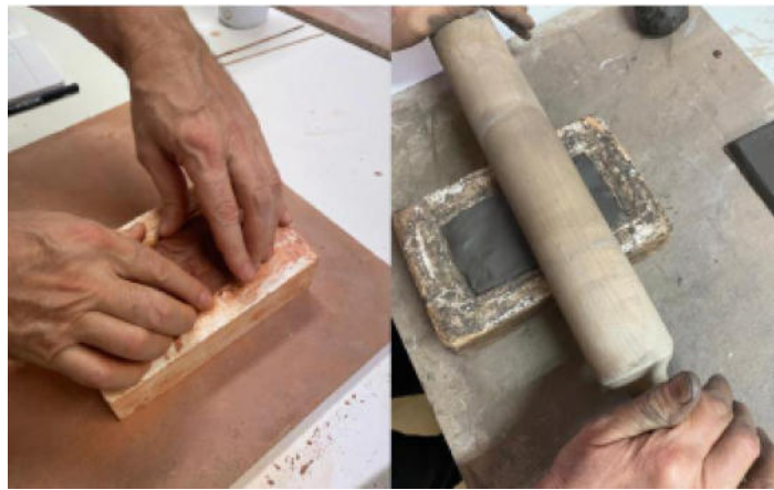
Preparación de las probetas por apretón en molde de escayola
