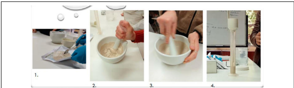
Preparación de las pastas y cálculo de su viscosidad
